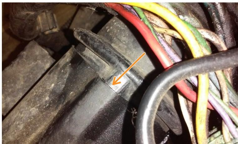
⚠ Attention avant de tout remonter contrôler la gaine en plastique quelle ne soit pas démanchée. Elle se trouve derrière le filtre à air pas très visible, il faut écarter le faisceau électrique pour voir.
