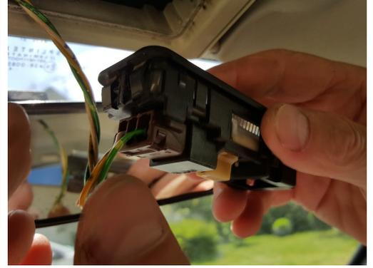
**i** Il y a un détrompeur sur le connecteur
