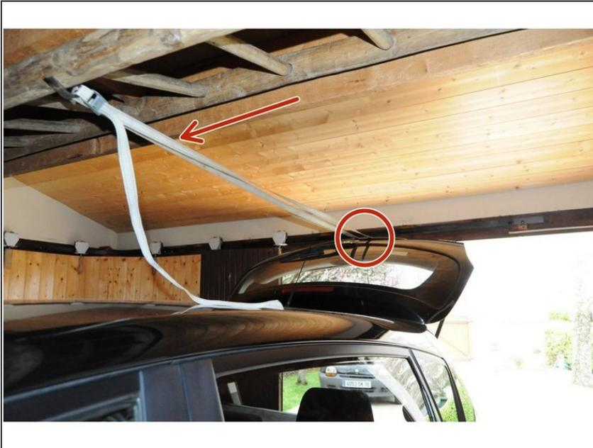
**⚠** Avant de commencer le démontage, il est très important de sangler le hayon au plafond du garage ou bien au crochet de remorquage situé à l'avant de la voiture, il est également possible de créer une béquille avec un manche à balai ou un tasseau qu'il conviendra de fixer pour éviter tout accident.
