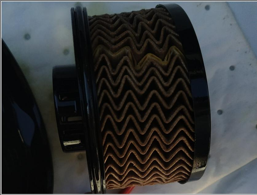
**⚠** Information importante : en fin d'intervention, il est nécessaire de remplir de filtre à gasoil et réamorcer le circuit. La méthode à l'aide d'un boîtier et logiciel est la plus indiquée (PSA COM et Obdlink-Sx pour ma part, testé avant l'intervention), les retours d'un amorçage "en démarrant" semblent peu conseillés (problèmes d'injecteurs).
