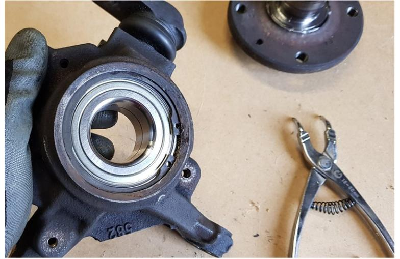
⚠ Ce [roulement](#) est équipé d'une bague d'impulsion magnétique. Il est impératif que la bague d'impulsion soit en face du capteur ABS lors du montage du roulement.
