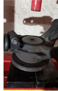
**⚠** Il faut avant tout placer un disque de  $\varnothing 65\text{mm}$  côté intérieur de la fusée pour éviter que le moyeu chasse la bague intérieure du [roulement](#).
