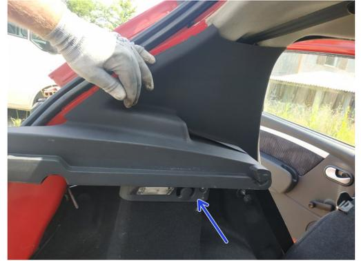
**i** Pour installer le faisceau, on va poser celui-ci dans le coffre. Il s'installe de l'intérieur vers l'extérieur de la voiture.
