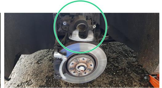
**i** Vous pouvez utiliser cette seconde méthode pour le démontage de l'étrier. Cela vous donne un peu plus de place au niveau de l'étrier et du disque pour le nettoyage entre autre.
