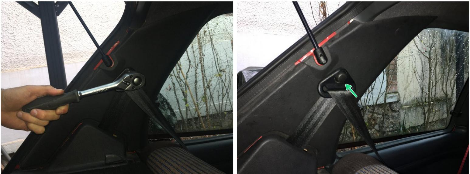
**i** Resserrer la vis avec un **cliquet** et une **douille de 17**
