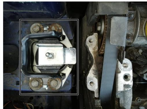
**⚠ S'assurer que le moteur ne provoque aucune contrainte sur les 3 vis**
