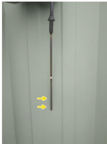
**⚠** Si vous avez utilisé des rampes de levage ou des chandelles, il va falloir absolument les retirer. Le niveau d'huile se fait impérativement sur sol plat.
