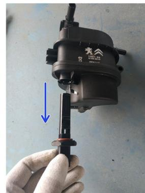
**i** Si le nouveau filtre n'a pas le réchauffeur (partie électrique), il va falloir le récupérer sur l'ancien.
