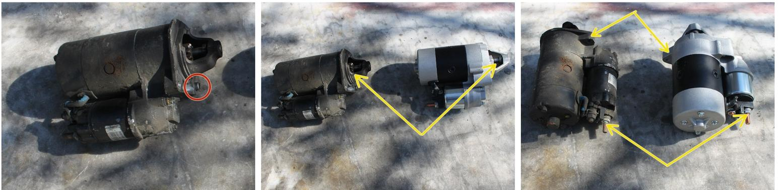
**⚠** Le démarreur est maintenu dans la bonne position grâce à une douille de centrage : vérifier que cette douille ne soit pas restée sur l'ancien démarreur, si tel est le cas, l'extraire à l'aide d'une pince et la replacer sur le nouveau démarreur à la main ou en vous aidant d'un maillet.
