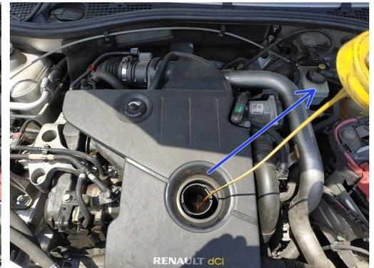
**i** La jauge d'huile est intégrée au bouchon de remplissage sur ce moteur.
