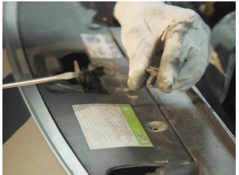
● A l'aide d'un **tournevis plat**, faites levier sur l'agrafe de fixation du pare-choc pour la retirer
