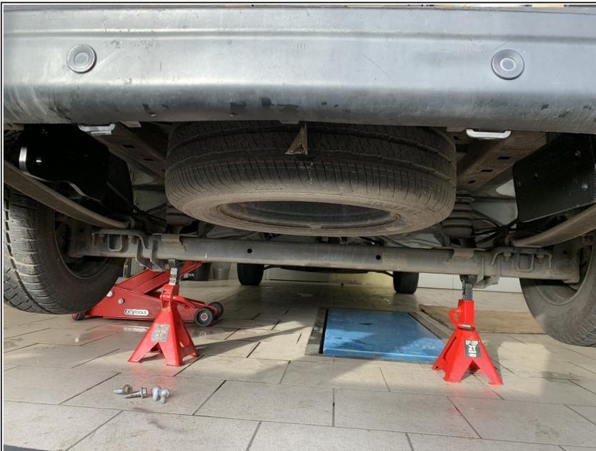
**⚠ Lever le véhicule et le mettre en sécurité sur chandelles**
