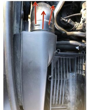
**!** dépose du filtre et du cache
