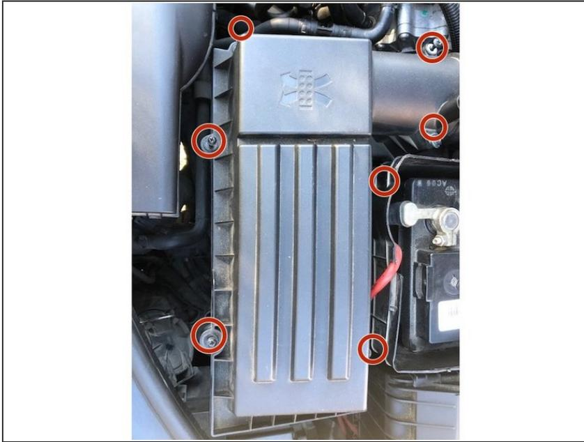
**i** dépose du filtre a air retirer les vis avec le tournevis étoile
