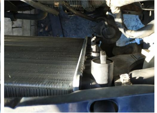
**i** Avant de démonter le radiateur, on va devoir libérer le canister (recyclage des vapeurs d'essence du réservoir).
