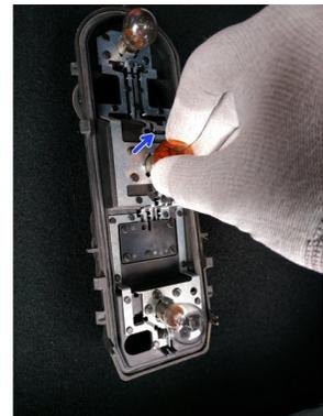
**!** Les ampoules du feu arrière ne sont pas toutes les mêmes. On remplacera chaque ampoule défectueuse par une ampoule absolument identique.
