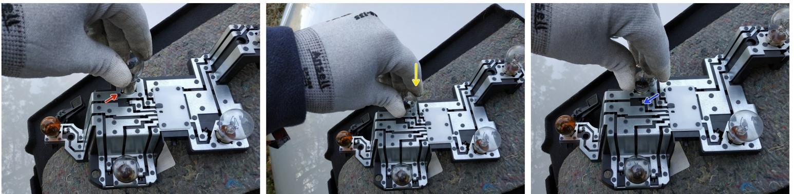
**⚠** Les ampoules du feu arrière ne sont pas toutes les mêmes. On remplacera chaque ampoule défectueuse par une ampoule absolument identique.
