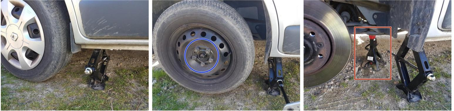
**⚠ Commencer par mettre la voiture sur chandelles pour surélever le train arrière. Mise en sécurité du véhicule : démontage et remontage de la roue.**
