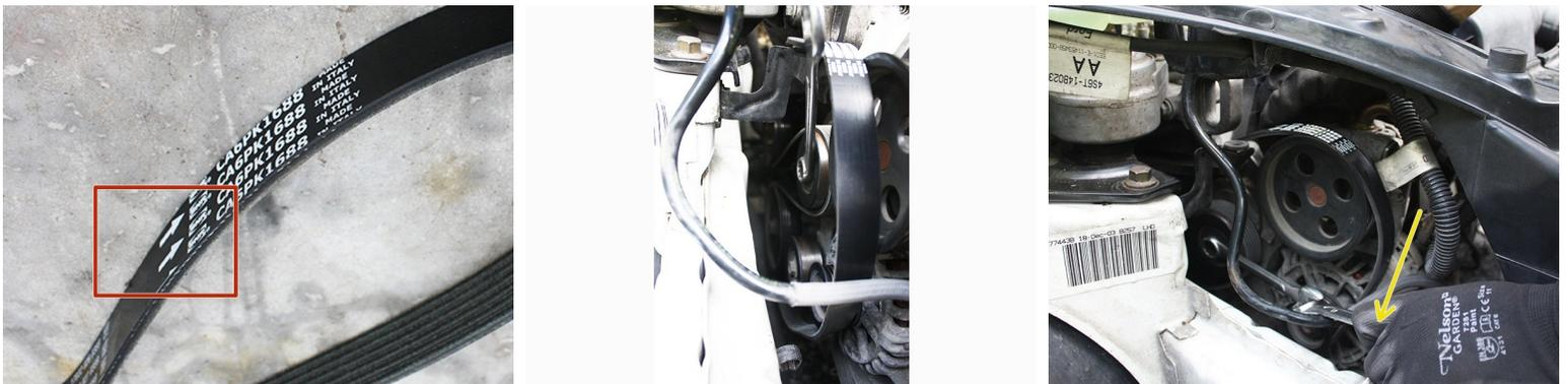
**⚠ La courroie possède un sens de montage à respecter (marquage flèche sur celle-ci) qui correspond au sens de rotation de la poulie de vilebrequin c'est à dire sens horaire.**
