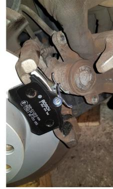
**i** Les [plaquettes](#) ont une feuille en papier sur leur faces d'appui car il y a de la colle dessus qui va permettre à la [plaquette](#) de rester en position sur l'étrier et le piston.
