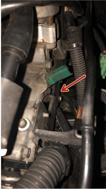
**⚠** En desserrant la sonde du liquide de refroidissement va s'écouler
