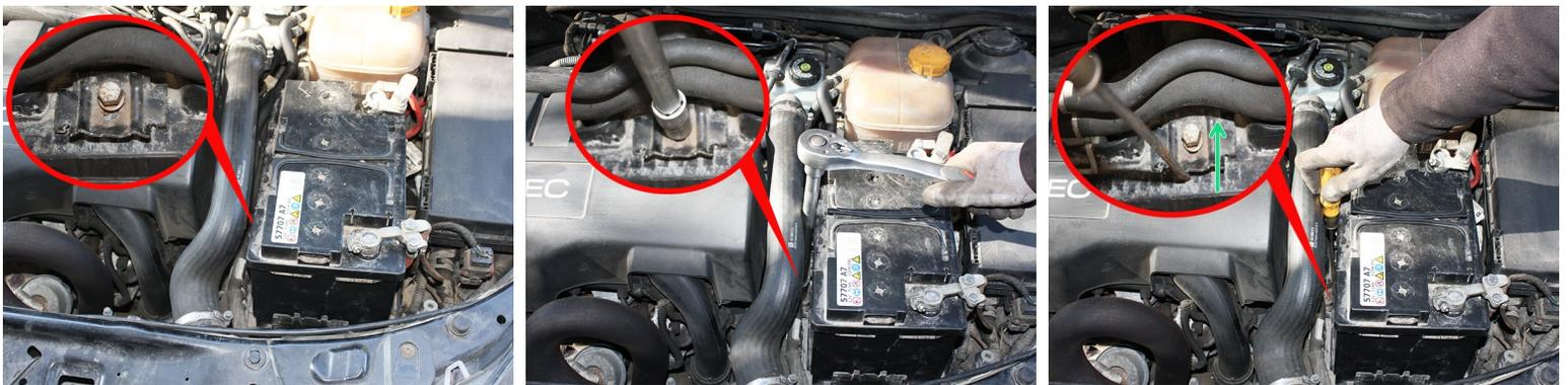
**i** La batterie est maintenu en place grâce à une bride serrée par une vis de 13mm qui se trouve au fond du bac à batterie visible en écartant légèrement la durite supérieur du radiateur de refroidissement. Pour extraire la batterie il suffit de desserrer cette bride sans la démonter.
