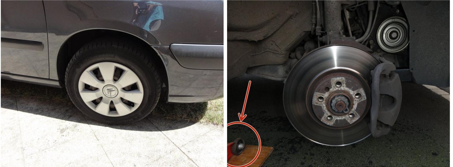
**⚠** Lever le véhicule et le mettre en sécurité sur chandelles. Caler le véhicule roue arrière avec une cale de bois par exemple.
