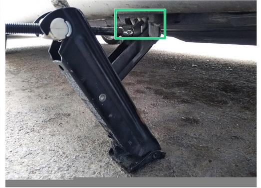
**⚠** Il est nécessaire de lever l'avant du véhicule pour remplacer la rotule de direction. "Procéder avec précaution."
