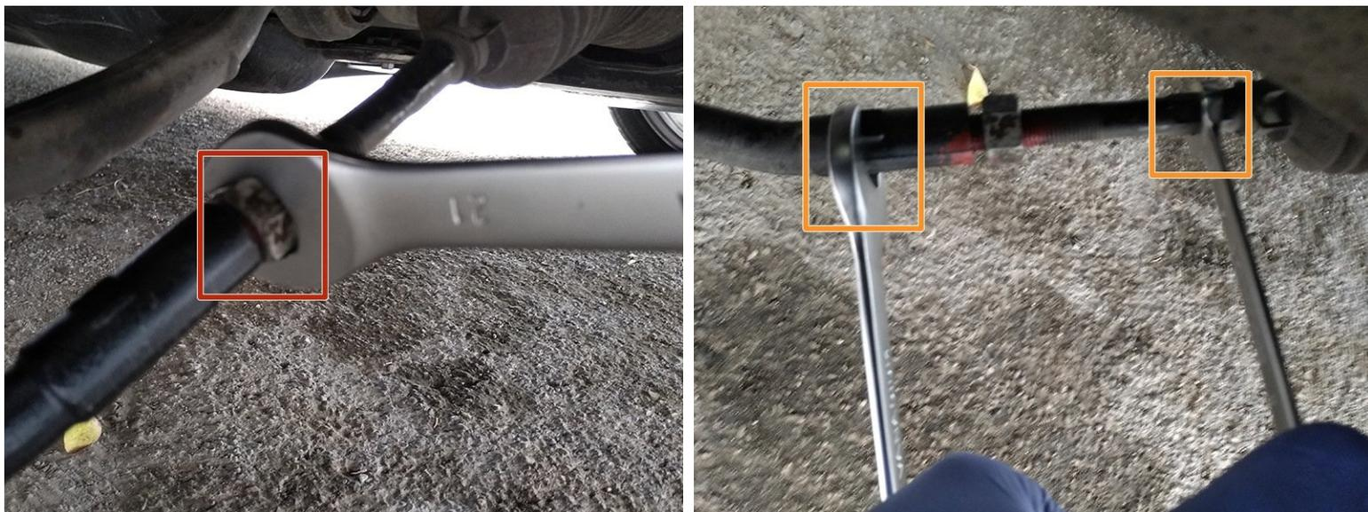
⚠ Afin de ne pas modifier le parallélisme, la rotule extérieure devra être remontée dans la même position sur la nouvelle rotule intérieure.
