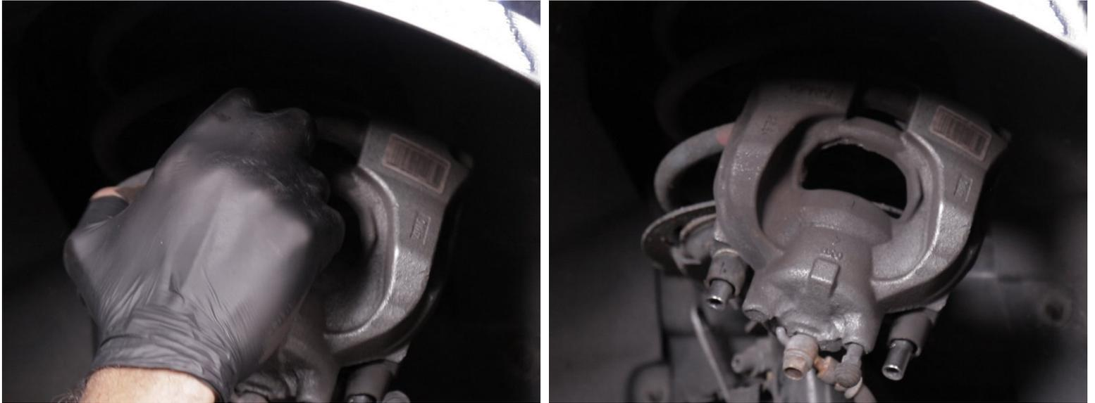
**i** Astuce : placer l'étrier sur le ressort de suspension pour ne pas détérioré le flexible de frein
