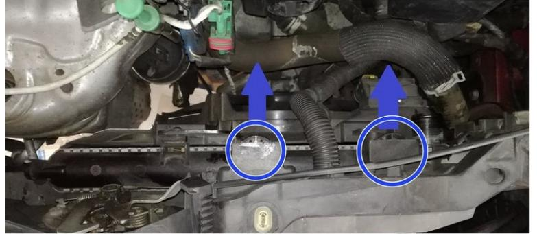
**i** le dessus du radiateur est maintenu par 2 pièces plastique, qui tiennent avec 2 clips.
