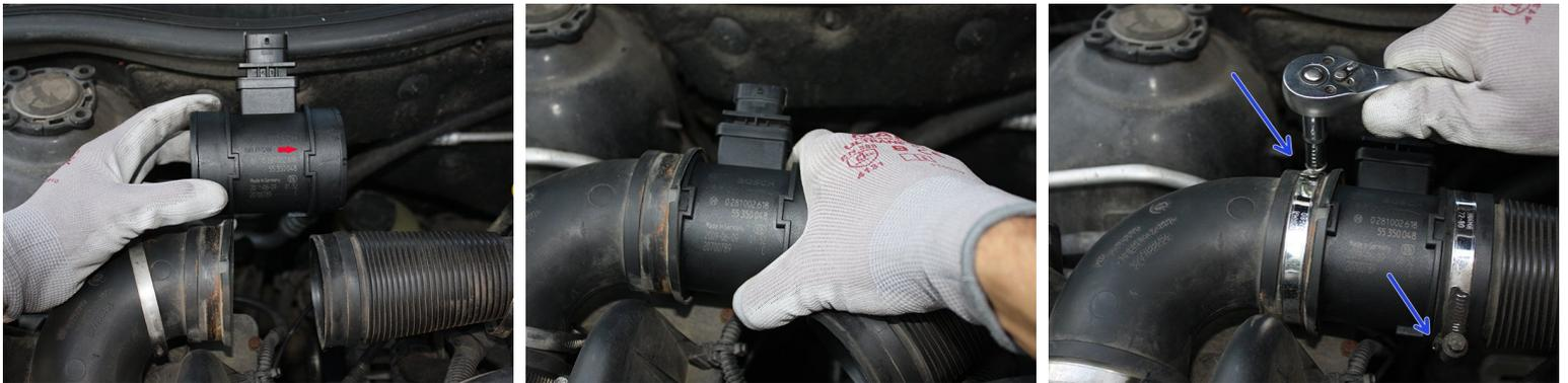
**⚠ Le débitmètre possède un sens de montage correspondant au sens de circulation de l'admission d'air indiqué par une flèche.**
