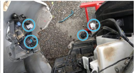
**⚠** Débrancher les câbles d'alimentation des projecteurs avants et les projecteurs antibrouillard.
