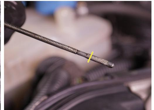
**⚠ Tirer la jauge à huile et la nettoyer avec un chiffon avant de vérifier le niveau**
