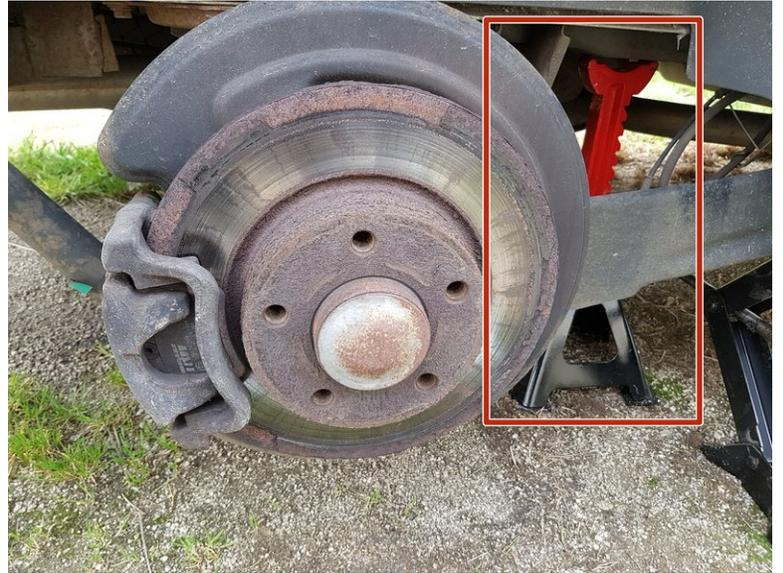
**⚠** Commencer par mettre la voiture sur chandelles pour surélever le train arrière. Mise en sécurité du véhicule : démontage et remontage de la roue.
