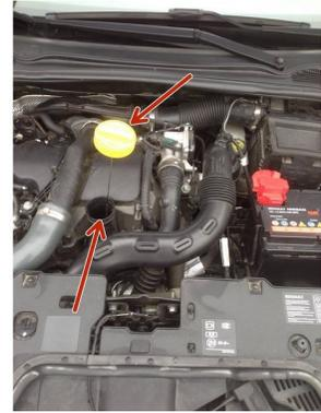
**i** Avant toute chose pour la vidange de votre Renault Clio IV 1.5DCI 75CV, "Faites tourner votre moteur environ 5/7 minutes pour que l'huile commence à chauffer et donc être plus fluide pour l'écoulement. Veuillez ouvrir votre capot grâce à la trappe situé sur le côté gauche de la porte conducteur au niveau du tapis de sol.
