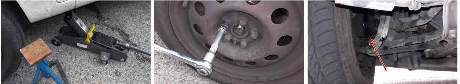
**⚠** La roue est soulevée du sol grâce au cric et la voiture sécurisée avec une chandelle.
