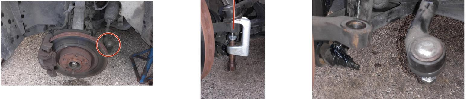
**i** Afin de dégager le cardan du moyeu il faut retirer la rotule de direction avec un extracteur.
