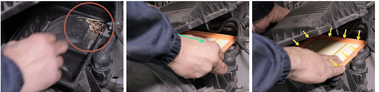
**⚠ Retirer les débris se trouvant dans la boîte à air avec une soufflette ou à la main afin de ne pas salir le nouveau filtre**
