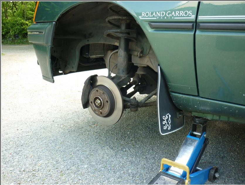
**⚠** Commencez par lever la voiture et retirer la roue en suivant ce tutoriel : [Mise en sécurité du véhicule : démontage et remontage de la roue](#)
