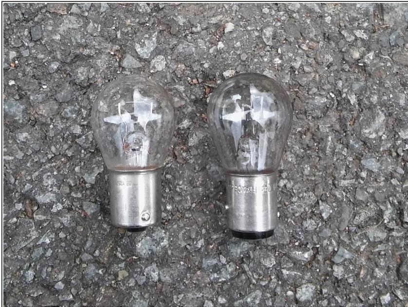
ⓘ Type d'ampoule : P21/5W
