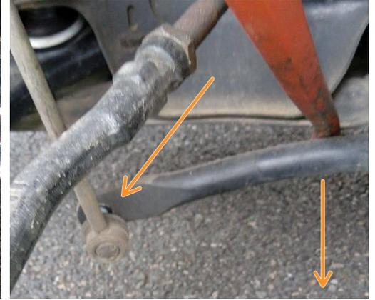
**⚠ Dévisser des deux cotés du véhicule l'écrou inférieure des biellettes de la barre stabilisatrice**
