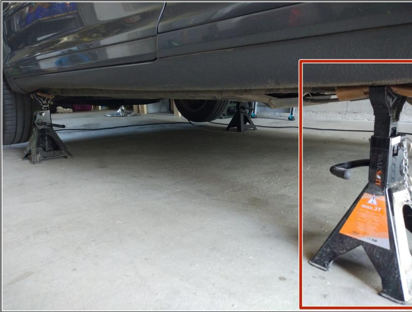
**⚠** il est nécessaire de décharger l'essieu arrière de toutes contraintes, pour cela placer la voiture sur chandelles (essieu arrière ou les deux comme sur la photos).
