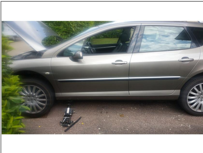
⚠️ **Faites chauffer le moteur pour avoir une huile plus fluide, lever le véhicule, et mettre une **chandelle** pour votre sécurité.**
