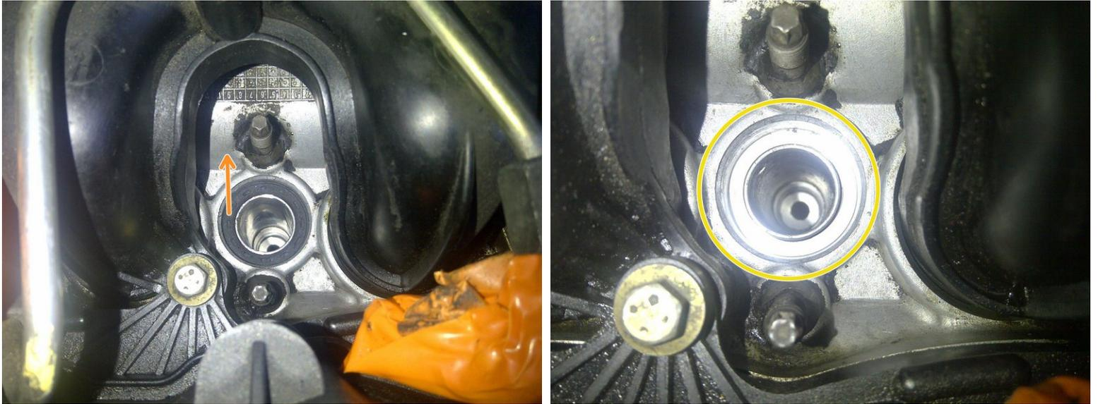
**⚠** A cette étape, veiller à ce qu'aucune impureté ne rentre dans la chambre de combustion (au fond du puits)
