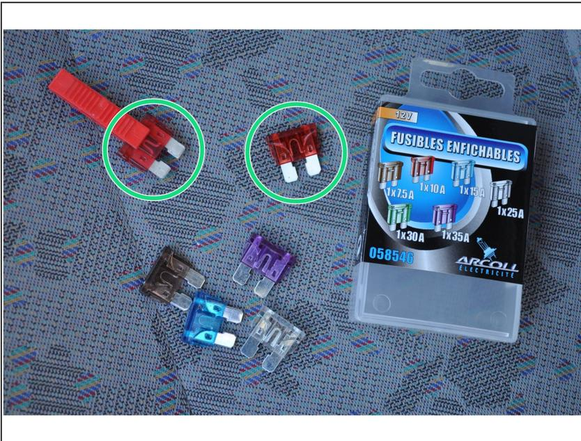
**⚠** Ne jamais remplacer un fusible grillé par des fils métalliques ou un autre matériel non approprié. Il faut toujours utiliser un **fusible** neuf de la même couleur
