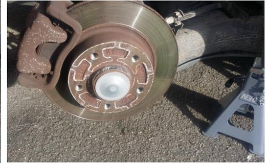
**⚠** afin de travailler en toute sécurité il est préférable sur le véhicule a l'arrêt d'enclencher une vitesse et de placer des cales derrière les roues opposées au levage de la voiture.
