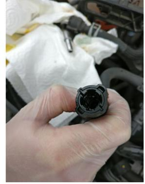
**i** Si les connecteurs sont bloqués, utilisé un tournevis plat pour les déclipser plus facilement
