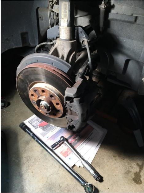
**⚠** Engagez une vitesse, serrez votre frein à main, commencer à desserrer légèrement vos goujons de roues à l'aide d'une clef dynamométrique (ou à défaut de l'outil Alfa situé dans le coffre),
