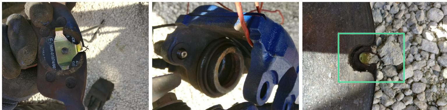
**⚠ La plaquette qui est en contact avec le piston est différente de l'autre, elle dispose d'une lamelle métallique qui viens se loger dans le piston.**
