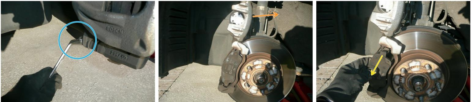
ⓘ Il est nécessaire de retirer les plaquettes de freins pour avoir accès aux disques.
