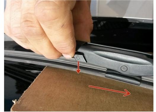
**i** Positionner un carton sur le pare brise avant
