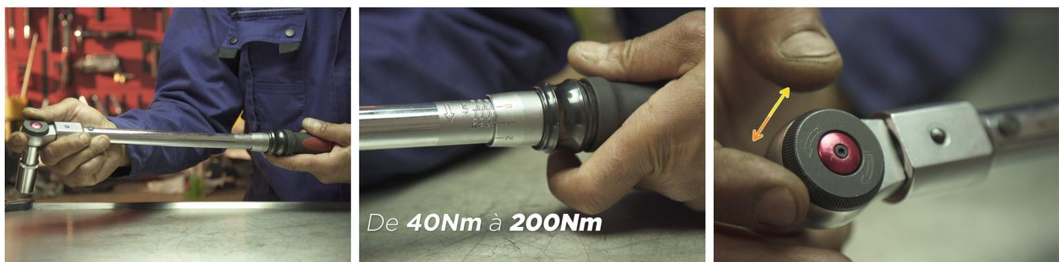
❗ La clé dynamométrique possède un réglage de couple en Nm au niveau de la poignée
