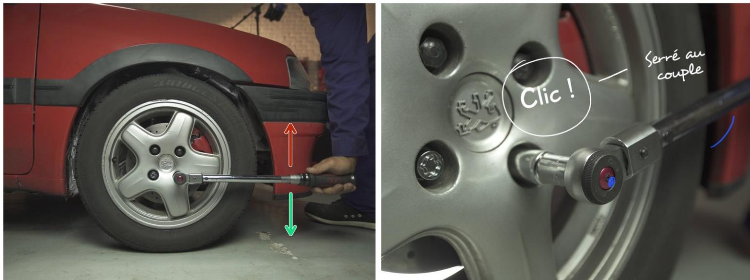
❗ Une clé dynamométrique est recommandée pour les serrages au couples
