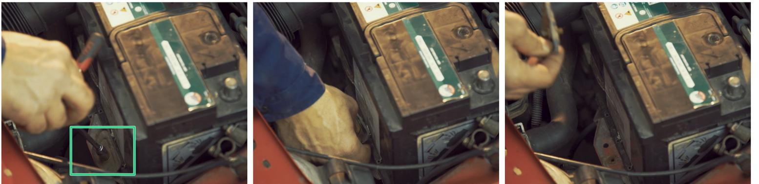
**i** Une plaque de fixation empêche la batterie de bouger et de se débrancher
